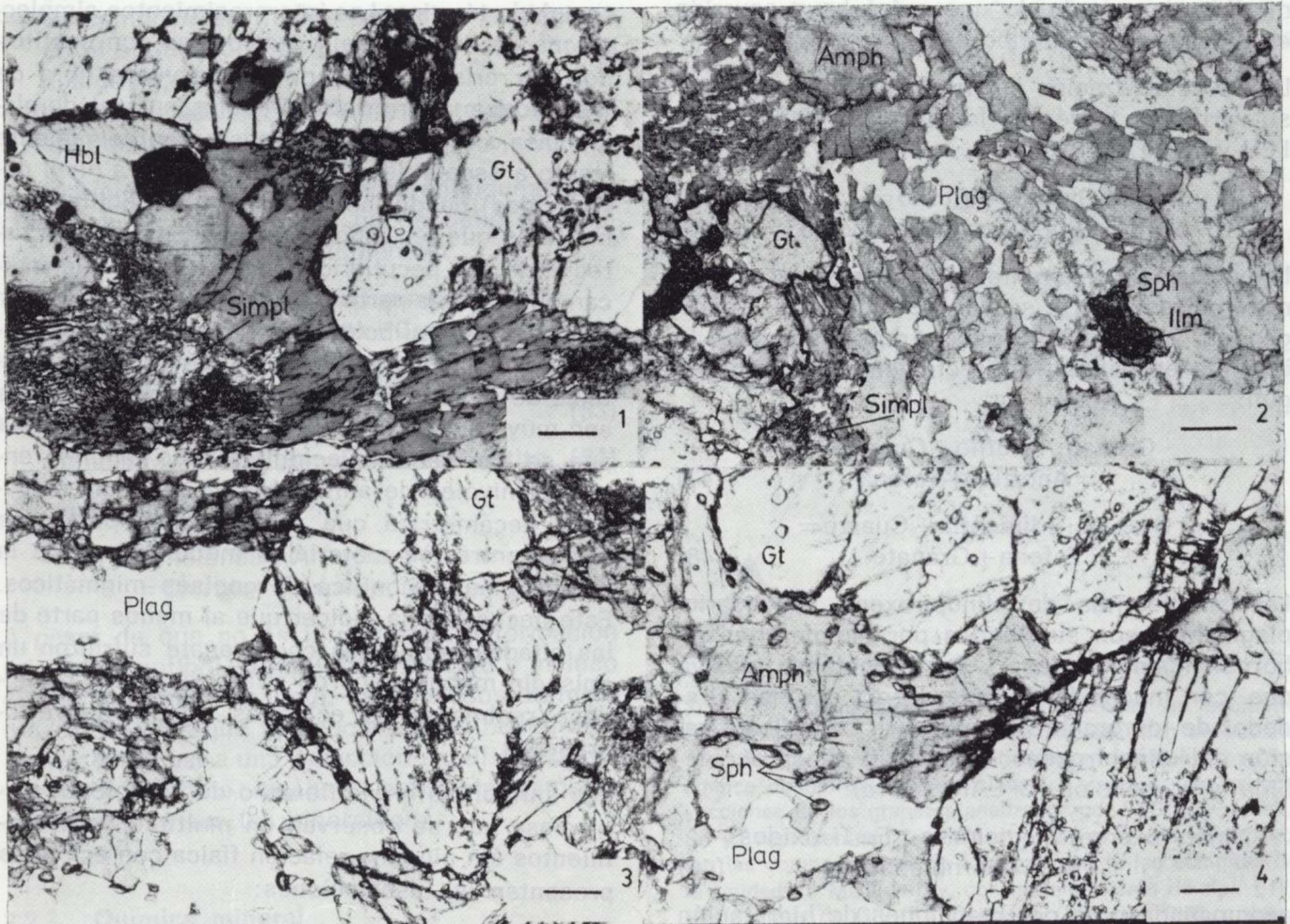
Ejemplos de asociaciones observadas en eclogitas retrogradadas con intensidad variable hasta anfibolitas granatíferas. 1, Eclogita en la que se ha desarrollado una amplia corona de anfíbol alrededor de granates a costa de la matriz simplectítica producto de los primeros estadios de retromorfosis en condiciones de presiones elevadas; 2, eclogita en la que la matriz simplectítica ha recristalizado totalmente, excepto en la inmediata proximidad de los granates, se observa también la formación de coronas de esfena alrededor de ilmenita; 3 y 4, las coronas simplectíticas han desaparecido casi totalmente, se reconocen como masas estrechas de aspecto anubarrado que rodean a los granates en algunas áreas, toda la ilmenita se ha convertido en esfena, aunque en el interior de algunos granates pueden quedar aún restos de rutilo. Barras de escala: 0.2 mm. Nícoles paralelos.
